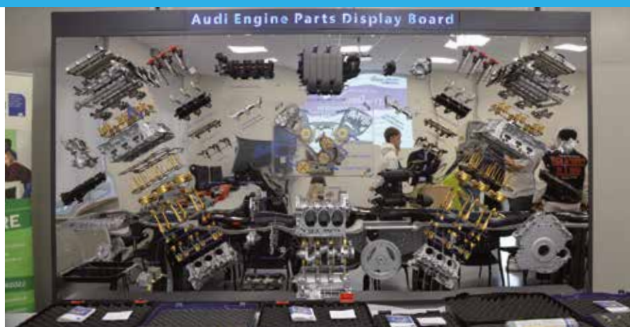
Piattaforma didattica complessa a pannello: motore Audi V6 di ultima generazione
